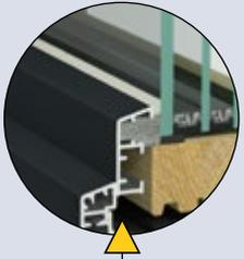
Ruhe genießen und Heizkosten sparen: ECO I Holz-Alu-Fenster werden wahlweise **2-FACH ODER 3-FACH VERGLAST** und einseitig mittels hochwertiger dauerelastischer **SILIKON-NASSVERGLASUNG** gefertigt.
