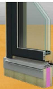
Die flache wärmegeämmte Bodenschwelle (PVC, ähnlich RAL 7035 Lichtgrau) in behindertengerechter Ausführung mit Purenit-Sandwich-Blindaufdoppelung. U-Wert ca. 0,7 W/m²K
