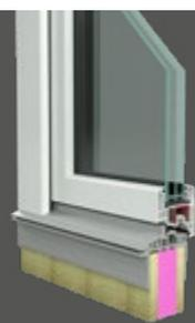
Die flache wärmege-dämmte Bodenschwelle (PVC, ähnlich RAL 7035 Lichtgrau) in behindertengerechter Ausführung mit Purenit-Sandwich-Blindaufdoppelung, U-Wert ca. 0,7 W/m²K
