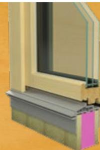
Die flache wärmegeämmte Bodenschwelle (PVC, ähnlich RAL 7035 Lichtgrau) in behindertengerechter Ausführung mit Purenit-Sandwich-Blindaufdoppelung. U-Wert ca. 0,7 W/m<sup>2</sup>K
