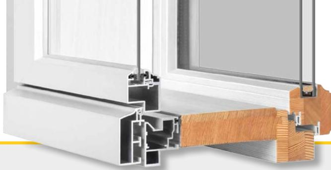
Beim Leistenpostenfenster sitzen die Außenflügel durch die spezielle Geißfußkonstruktion außen, öffnen jedoch nach innen. Dadurch ergibt sich eine möglichst große Glasfläche und somit mehr Lichteinfall. Die Ausführung ist in Leibung sitzend oder vor Fassade sitzend möglich.
